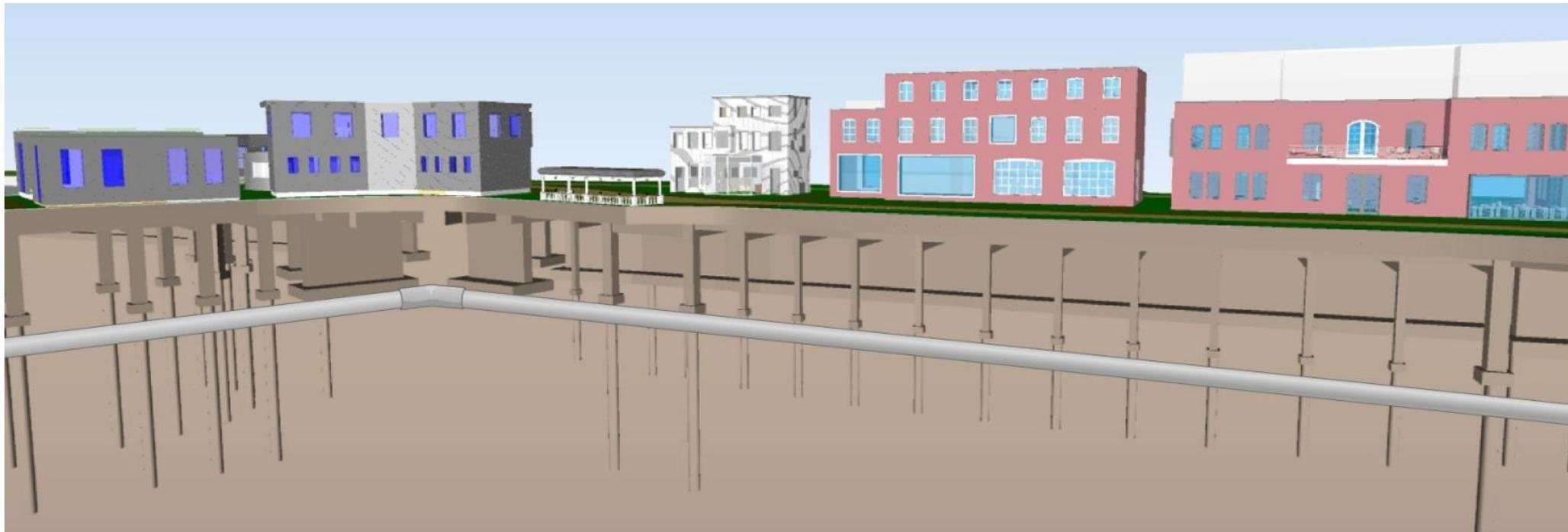
Bei der Wärmeentnahme aus den Speichern wird die temperierte Sondenflüssigkeit bei Heizbedarf aus dem Boden hochgeleitet und – ebenso wie die Sole aus den PVT-Modulen – unterirdisch zum Keller der nächstgelegenen Versorgungszentrale geleitet
