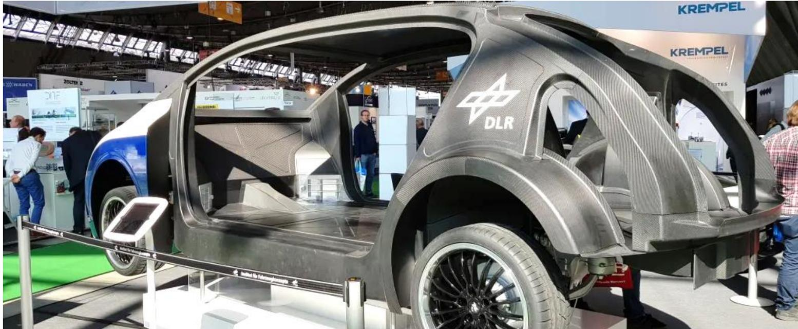
德国航空航天中心 (DLR) 已经开发了一些轻量级的汽车车身--例如这种含有高比例纤维强化塑料的多材料车身结构。
